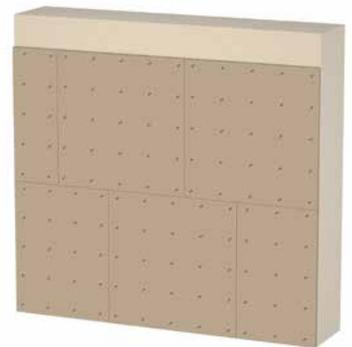
Trockenputzplatte aus Lehm und Schilf zum flächigen Bekleiden von Holz- und Holzwerkstoffen sowie Altputzen und Massivbaustoffen. Die Claytec-Lehmtrockenputzplatte dient der Verbesserung des Raumklimas im Trockenbau. Sie entstand aus handwerklicher Erfahrung und ist seit 20 Jahren am Markt. Ihr handliches Format macht sie gut verarbeitbar. Zum Kleben und Bewehren ist Lehmklebe- und Armierungsmörtel geeignet. Zur Konformität DIN 18948 s. Hinweis auf der Rückseite.
