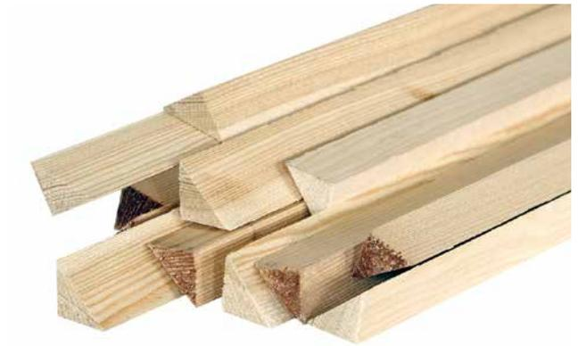
Lärchenholzleisten für die Verbindung zwischen Mauerwerk und Fachwerkbalken. Der Querschnitt ist auch für alte unregelmäßige Balken ausreichend biegsam und anpassungsfähig. Die Höhe entspricht genau der Dicke der Gefachabschließenden Lehmörtelfuge. Lärchenholz ist stabil, beständig und sehr gut zu nageln.
