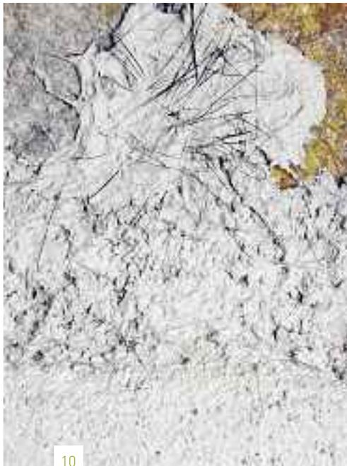
**Besondere Hinweise** In mineralischen Grundputzen können während dem Abbinden Schwindrisse entstehen. Empfehlung: mehrschichtiger Auftrag, feucht halten. Der frische Putz darf nicht abtaloziert werden, bis zum Anstrichauftrag muss der Putz genügend karbonatisiert sein. Ausnahme: HAGA Kalkfarbe kann nass in nass «al fresco» ausgeführt werden.
