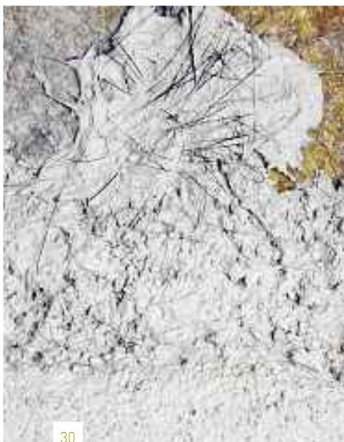
**Indicazioni particolari** Durante l'applicazione negli intonaci di fondo minerali possono formarsi delle incrinature da contrazione. Raccomandazione: in caso di applicazione multistrato, mantenere umido. L'intonaco appena applicato non potrà essere levigato; prima dell'applicazione di vernice, l'intonaco deve essere sufficientemente carbonato. Eccezione: HAGA Kalkfarbe (pittura alla calce HAGA) può essere applicata sull'umido, «al fresco».
