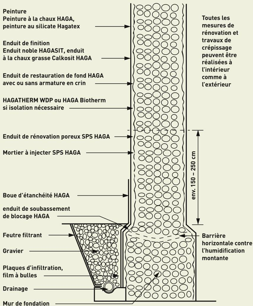
**Détail** HAGA Sanierporenputz-System SPS (système d'enduit de rénovation poreux SPS HAGA) et HAGA Restauriergrundputz-System (système d'enduit de restauration de fond HAGA), intérieur et extérieur, façades, soubassements et souterrains
