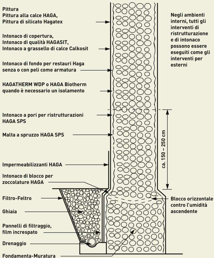
**Dettagli** HAGA Sanierporenputz-System SPS (sistema intonaco a pori per ristrutturazioni SPS HAGA) e HAGA Restauriergrundputz-System (sistema intonaco di fondo per restauri HAGA) all'esterno e l'interno su facciata, zoccolo e sottofondo
