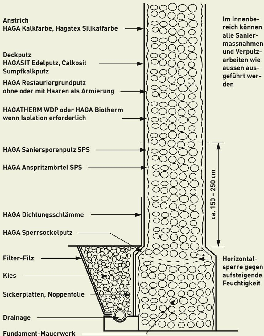
**Aufbauschema** HAGA Sanierporenputz-System SPS und HAGA Restauriergrundputz-System aussen und innen im Fassaden-, Sockel- und Unterterrainbereich
