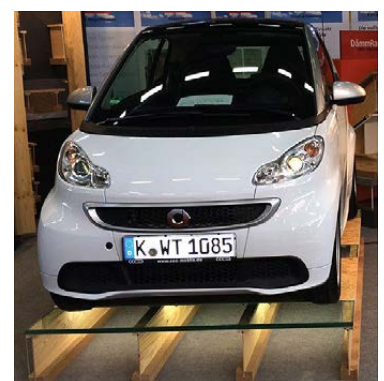
875 kg Smart auf einem 3,5 m 2 großen Podest. Belastung: 250 kg/m 2
