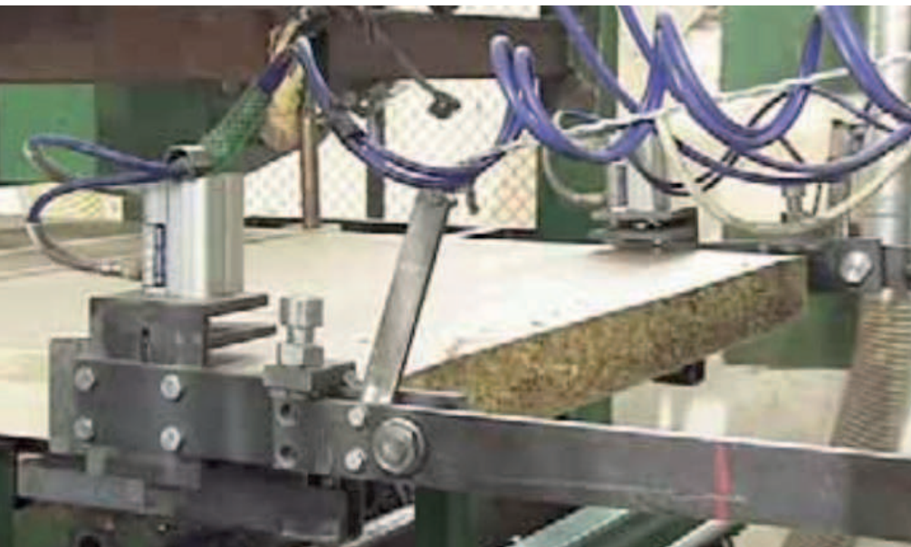
Herstellung der Strohbauplatten
