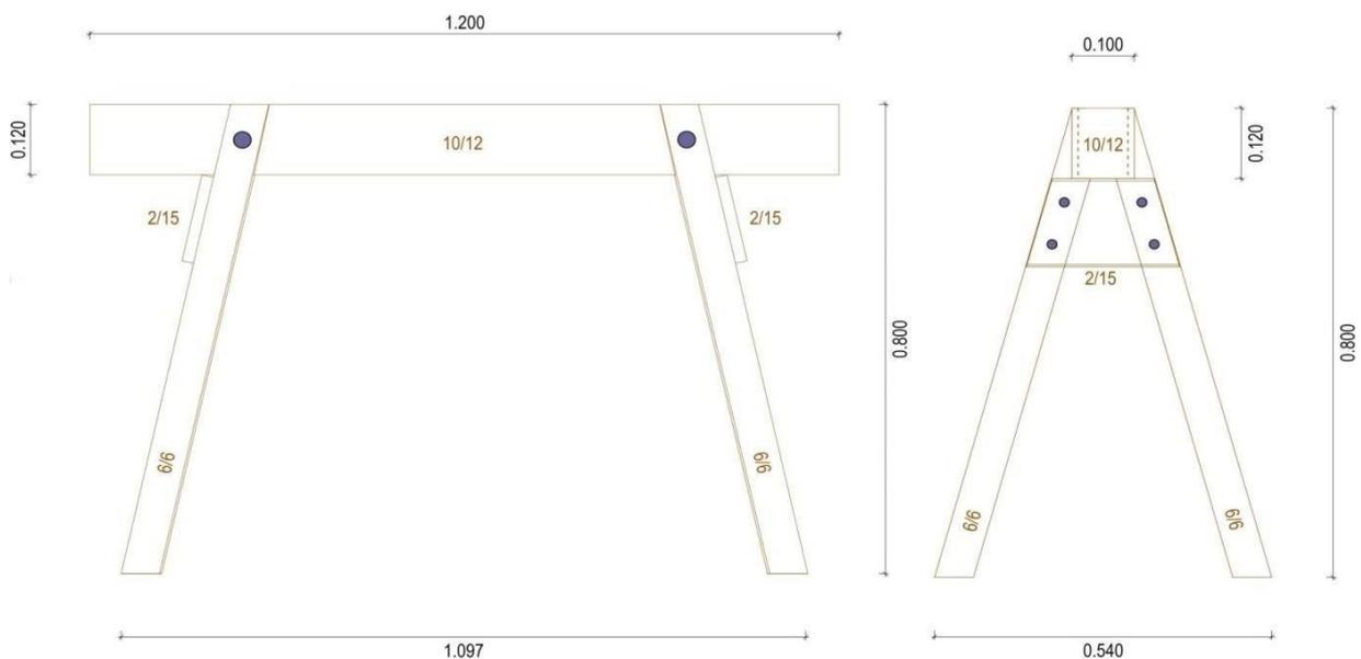
Die 4 Füße werden in die Aussparungen des Auflagerholzes eingesetzt. Dabei unbedingt auf die Ausrichtung der Füße (links oder rechts) achten.
