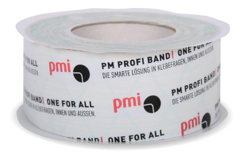
PM PROFI BAND ist ein weiches, sehr schmiegsames Spezialfolien-Klebeband mit einem äußerst haftstarken Polyacrylat-Haftklebstoff mit extrem hoher Klebkraft und überragender Alterungsbeständigkeit auf einer sehr weichen und schmiegsamen mit Fadengelege armierten PE-Deckfolie mit rückseitigem Trennpapier.
