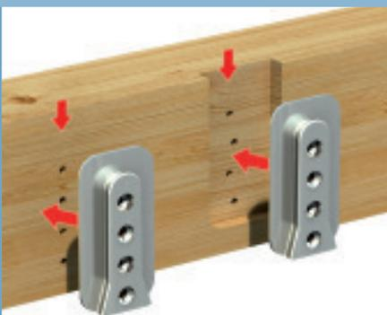
An den Stirnflächen sind bei allen SHERPA®-Teilen Mittellinien zur leichteren Positionierung angebracht.
