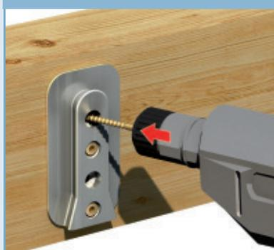
Zur Positionierung zuerst gerade schrauben vorbohren und einschrauben, dann die schrägen Schrauben vorbohren und eindrehen.
