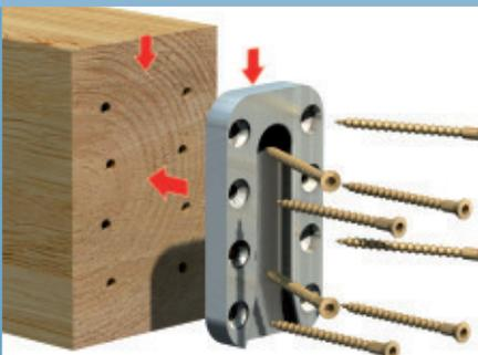
Jener Verbinderteil mit der größeren Anzahl an Bohrungen wird am Hirnholz des Nebenträgers montiert.
